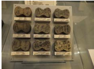
100年分のコンクリートのテストピース (6万個)
